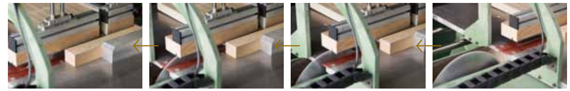
円型のノコギリ刃が回転して移動し、紙を切る。
